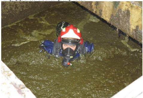
Auch unter Wasser oder in Jauchegruben bleibt der Anzugträger dank des dichten Reißverschlusses und der eng anliegenden Halsmanschette trocken (Bild: Pedi).
