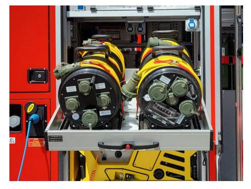
Ein besonders praktisches Detail ist die integrierte Keilbremse. Sie verhindert ein ungewolltes Nachrollen der Leitung beim schnellen Abziehen (Bild: GIFAS).
