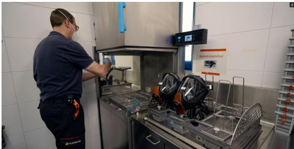
Bestückung des Korbes mit Lungengautomaten zur Reinigung und Desinfektion. Der Atemschutzgerätewart schiebt einen Lungengautomatenkorb durch Schleuse und trennt die Druckbeaufschlagung vom Gerät »TopClean H« (Bild: Meiko).
