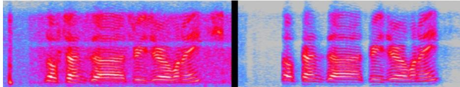
Das Audio-Spektrogramm zeigt deutlich die Rauschunterdrückung (rechts).
