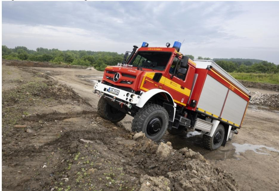
Zur weiteren Verbesserung der Traktion im sandigen oder matschigen Gelände kann über die Reifendruckregelanlage TireControl Plus die Aufstandsfläche der Reifen per Knopfdruck angepasst werden.
