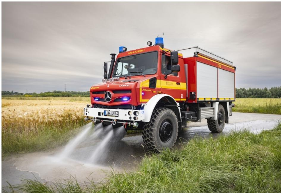
Dank der vier Frontsprühdüsen unter der vorderen Stoßstange ist auch das Überfahren flacher, brennender Vegetation möglich (Bilder: Daimler Truck).
