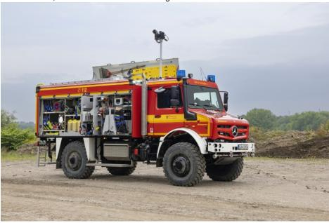
In den vier seitlichen Geräteräumen ist Platz für eine umfangreiche feuerwehrtechnische Beladung, zu der unter anderem Schläuche, Strahlrohre, Atemschutzgeräte, Werkzeuge und ein Stromerzeuger gehören.
