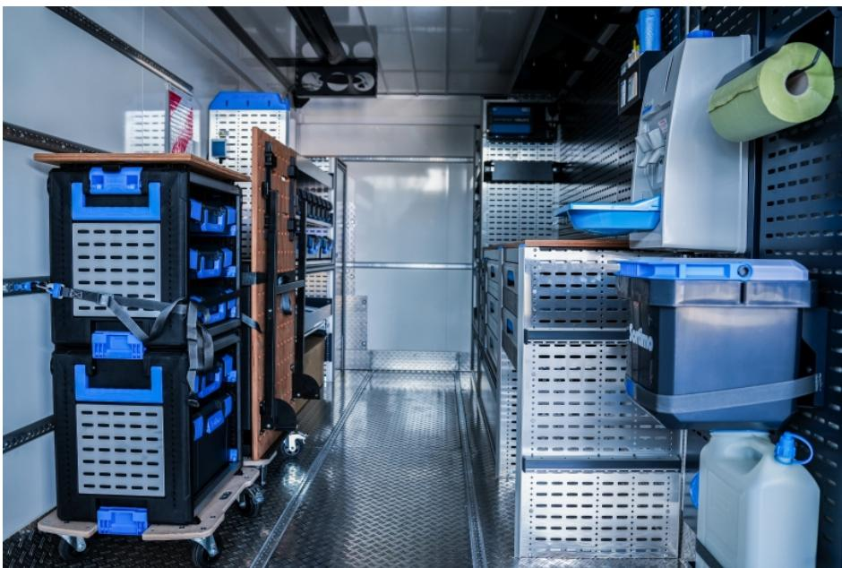
Ein Blick ins Innere zeigt: Die klar strukturierte Fahrzeugeinrichtung von Sortimo sorgt dafür, dass Werkzeuge und Materialien sofort griffbereit sind und die Einsatzkräfte ohne Zeitverlust arbeiten können (Bild: Sortimo).
