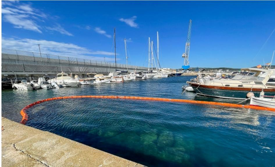
Test der »HARBO Boom« in einem kleinen Yachthafen – ein idealer Einsatzort für das ebenso leichte wie flexible System (Bild: RAW Handel und Beratungs GmbH).
