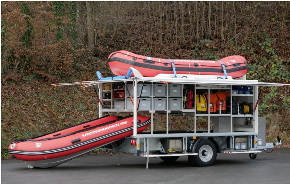
Geräteanhänger »GAnh-SFW-Rett NRW« für die Strömungs- und Fließwasserrettung (Bild: Ewers).
