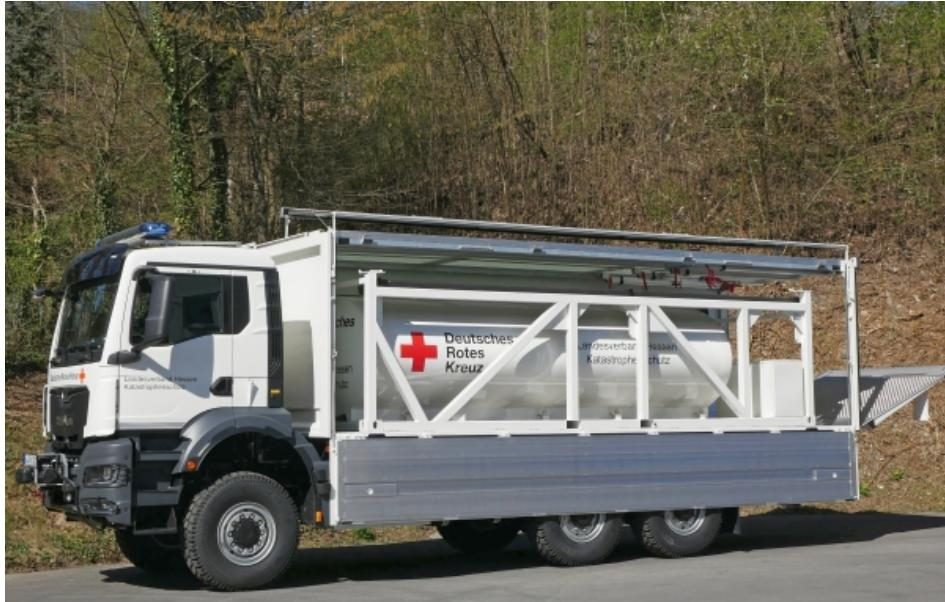
Der Lkw ist hier mit einem Stahlrahmen für einen 10.000-l-Trinkwassertank bestückt
