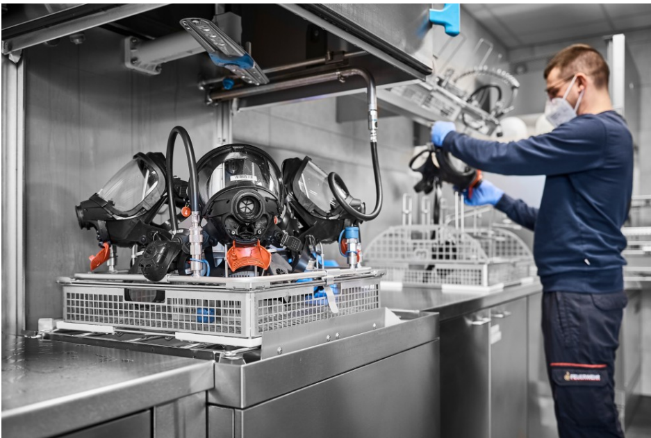
Reinigung und Desinfektion mit der TopClean H. (Bild: MEIKO Deutschland GmbH)
