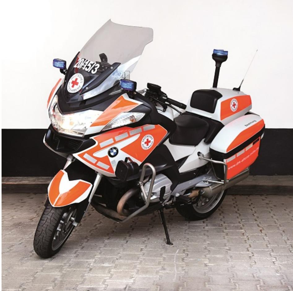
Wilmering stellt eine neue Sondersignalanlage für Einsatzmotorräder vor. Diese besteht aus: zwei LED-Blaulichtern nach vorne, einem LED-360°-Stativblaulicht im Heckbereich, einer Tonfolgeanlage mit zwei Lautsprechern, einem Kabelsatz sowie einer Schalter-Bedieneinheit. Zulassungen für Blaulicht und Ton liegen vor.
