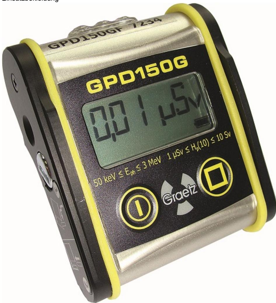
Im Bereich des ABC-Schutzes sind Feuerwehrkräfte bei A-Einsätzen für den persönlichen Strahlenschutz entsprechend FwDV 500 mit Alarmdosimetern
