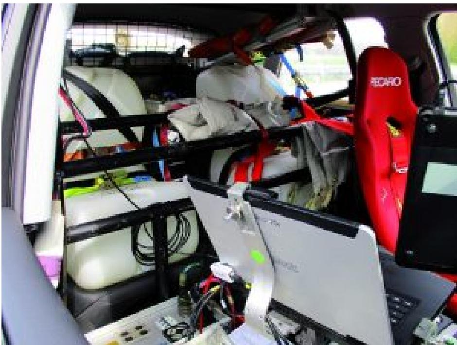
Auf der Beifahrerseite befindet sich die Messtechnik und hinten ein simulierte Gewicht für Heckausbau und Beifahrer.
