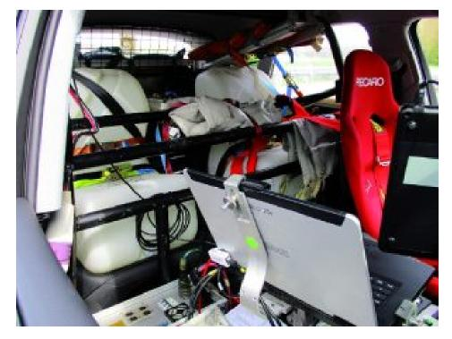
Auf der Beifahrerseite befindet sich die Messtechnik und hinten ein simuliertes Gewicht für Heckausbau und Beifahrer.
