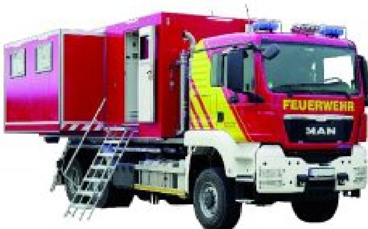
Dadurch dass beide Seitenwände seitlich ausgefahren werden können, lässt sich die Besprechungsfläche von 10 auf beachtliche 20 m<sup>2</sup> verdoppeln – und dies bei absolut ebenem Boden.
