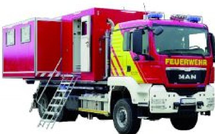
Dadurch dass beide Seitenwände seitlich ausgefahren werden können, lässt sich die Besprechungsfläche von 10 auf beachtliche 20 m<sup>2</sup> verdoppeln – und dies bei absolut ebenem Boden.
