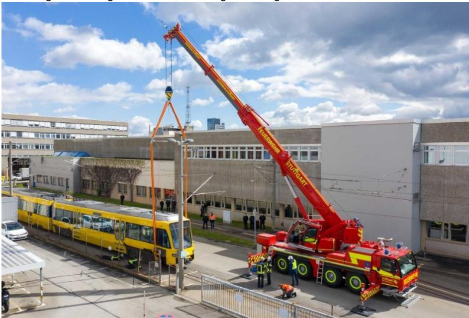
Einer von zwei neuen Feuerwehrkränen der BF Stuttgart. Fahrgestell ist ein Liebherr »LTM 1070 4.2« mit Sechs-Zylinder-Dieselmotor (Bild: Liebherr).
