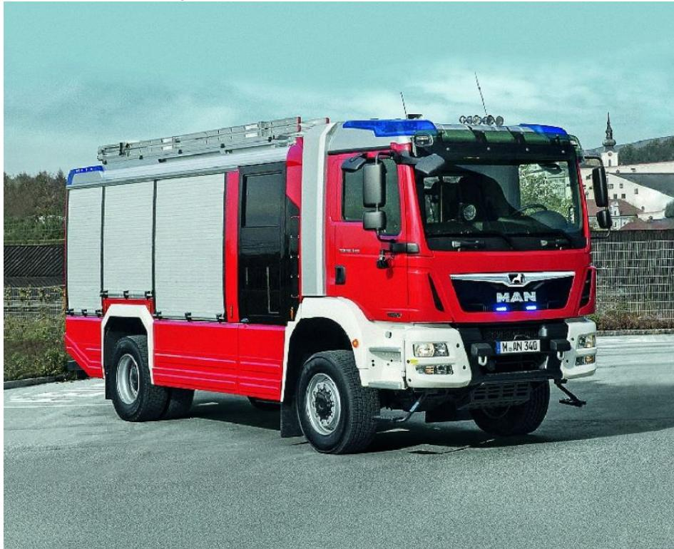
Ein MAN TGM als Hilfslöschfahrzeug (HLF) mit Aufbau von Rosenbauer. Bei der TGM-Baureihe besteht die Wahl zwischen Straßen- und Allradantrieb und Fahrgestellen für 13 bis 18 t zul. Gesamtgewicht.
