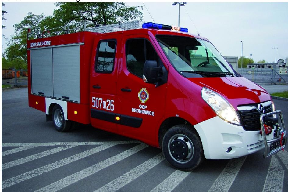
Die Allradumrüstungen für den Opel Movano bietet einen zuschaltbaren Allrad sowie eine zuschaltbare Getriebeunterstützung ( $i = 1,42$ ). Die Getriebeunterstützung bietet somit auch im Anhängerbetrieb ein kupplungsschonendes Fahren (Oberaigner Automotive).
