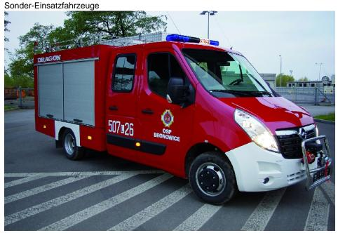
Die Allradumrüstungen für den Opel Movano bietet einen zuschaltbaren Allrad sowie eine zuschaltbare Getriebeuntersetzung (i = 1,42). Die Getriebeuntersetzung bietet somit auch im Anhängerbetrieb ein kupplungsschonendes Fahren (Oberaigner Automotive).
