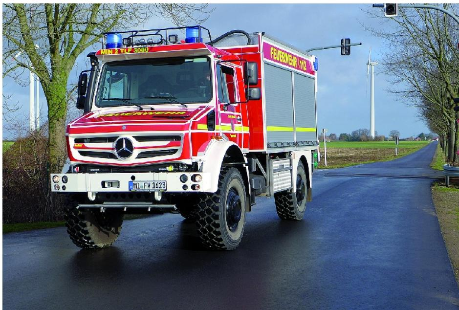
Die Schnellangriffseinrichtung hinter dem Fahrerhausdach wird durch die Dachluke des Unimogs bedient (RKF-Bleses) .
