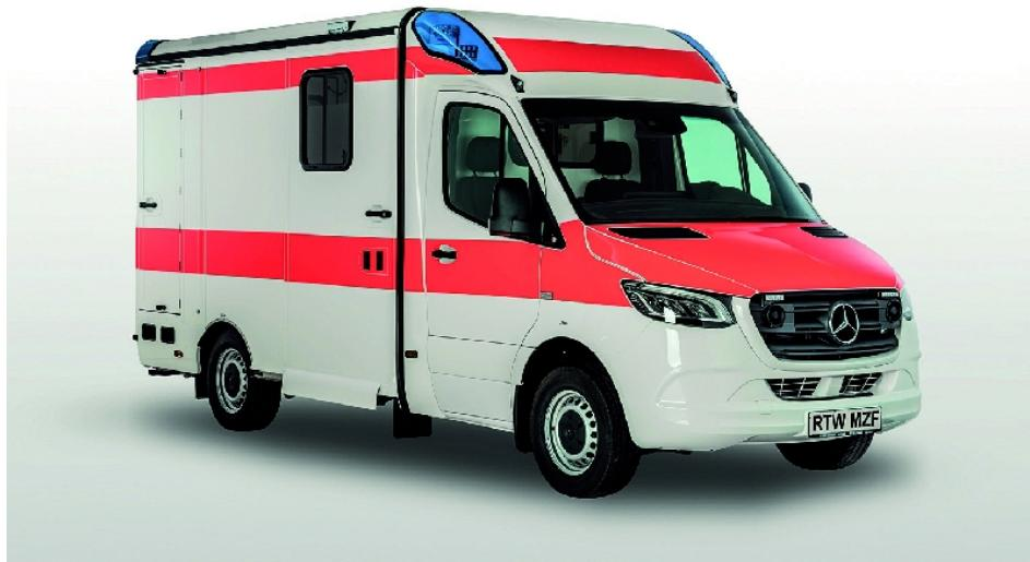
RTW-Kofferaufbau von System Strobel auf Basis des neuen MB-Sprinters. Als Neuheit ist hier eine eigens entwickelte, luftgefederte Patientenlagerung namens Aero Komfort verbaut.
