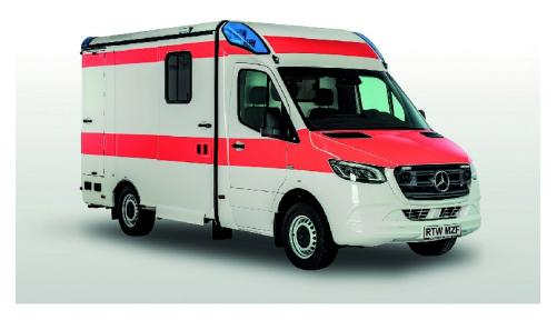
RTW-Kofferaufbau von System Strobel auf Basis des neuen MB-Sprinters. Als Neuheit ist hier eine eigens entwickelte, luftgefederte Patientenlagerung namens Aero Komfort verbaut.
