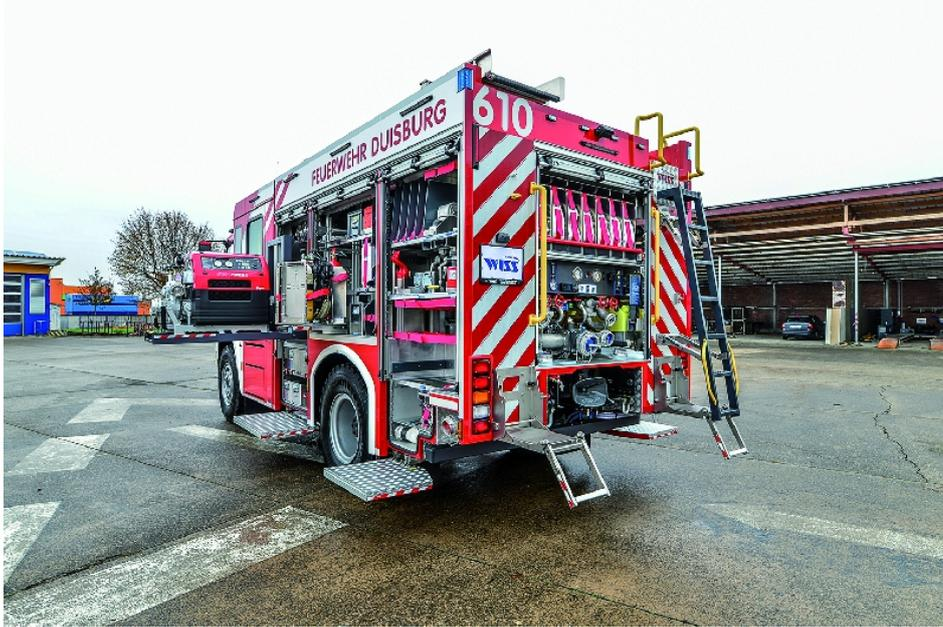
Im Fahrzeugheck lagern insgesamt 21 B-Druckschläuche über dem Pumpenbedienstand und können bei Bedarf während der Fahrt verlegt werden (Thoma Wiss).
