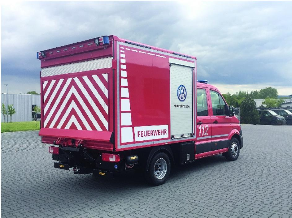
Der Kofferaufbau des GW-L1 verfügt über Rollos zur seitlichen Entnahme von Gerätschaften (Volkswagen).
