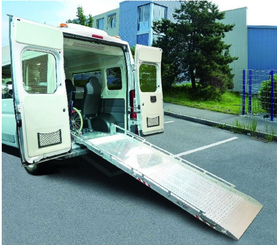
Faltbare Rampe aus Aluminium als stabile und rutschfeste Auffahrhilfe in Fahrzeugen (Altec).
