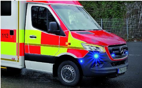
Sicher über jede Kreuzung – die Kreuzungsblitz-Ausführung mit sechs »Sputnik Mini«-Leuchtenkörpern als HT-Lösung von Hänsch Warnsysteme (Bild: Hänsch).
