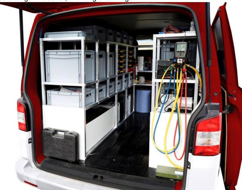
Mit dem »Alusteck«-System lässt sich der Fahrzeugausbau flexibel und kostenoptimal ausführen (Bild: Variosmart).
