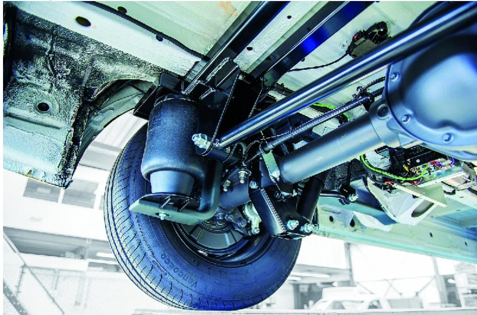
Eine VB-FullAir2C für einen MB-Sprinter 3,5 t der zweiten Generation von VB-Airsuspension.
