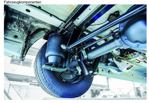
Eine VB-FullAir2C für einen MB-Sprinter 3,5 t der zweiten Generation von VB-Airsuspension.
