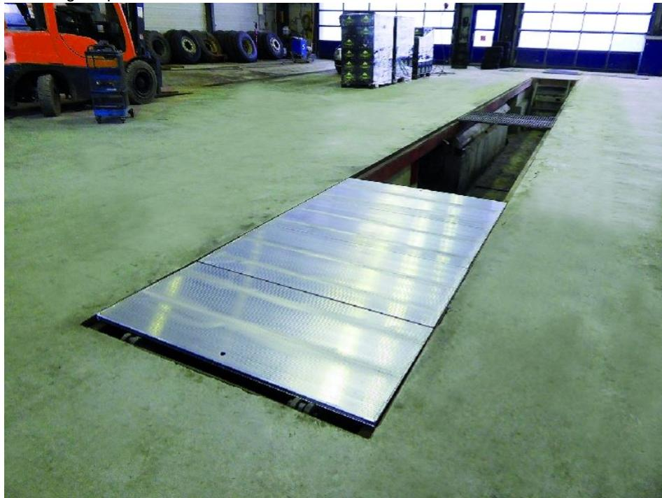
Die neue Altec-Grubenabdeckung sorgt für mehr Sicherheit in der Werkstatt.
