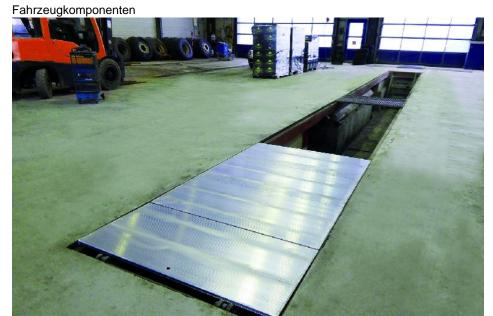
Die neue Altec-Grubenabdeckung sorgt für mehr Sicherheit in der Werkstatt.
