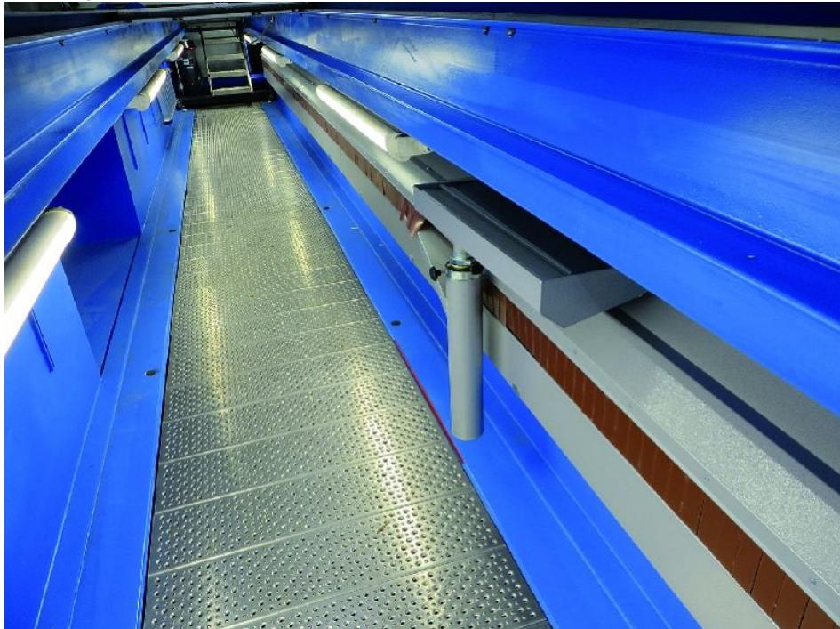
Balzer entwickelt und produziert die einteilige Fertigteil-Montagegrube bis 40 m Länge und mehr.
