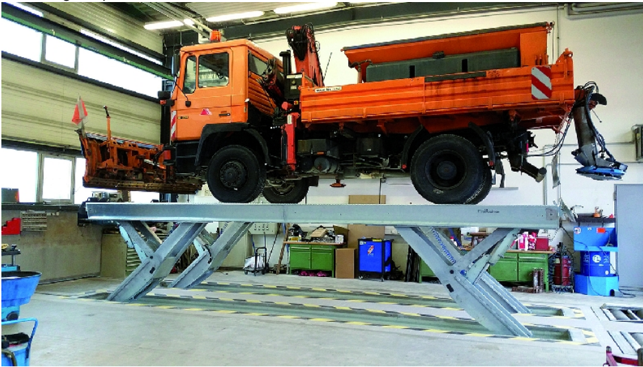
Feuerverzinkte Fahrschienenbühne HDS von Finkbeiner.
