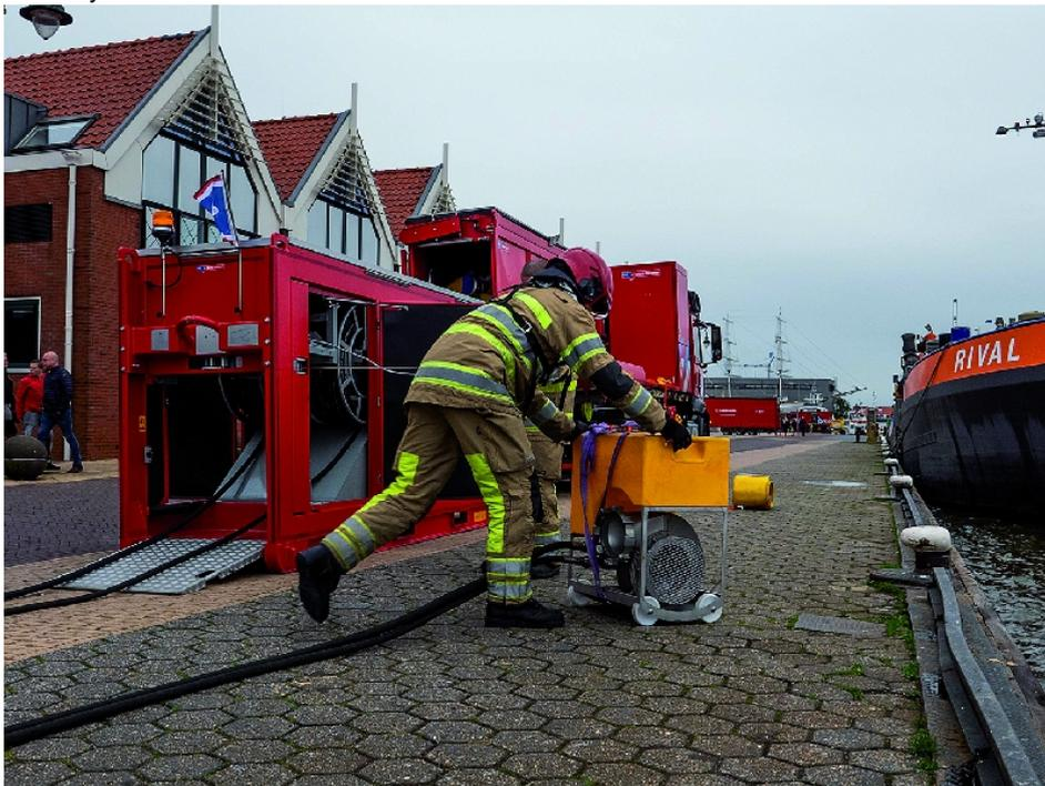
Das Wasserfördersystem HydroSub als Abrollcontainer-Lösung mit Pumpeneinheit und 2000 m Schlauch.
