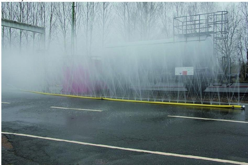
Der iconos Düsenschlauch kann mit bis zu 15 Düsen mit einer unterschiedlichen Anzahl an Loch-Querschnitten von 2 bis 6 mm ausgerüstet sein.
