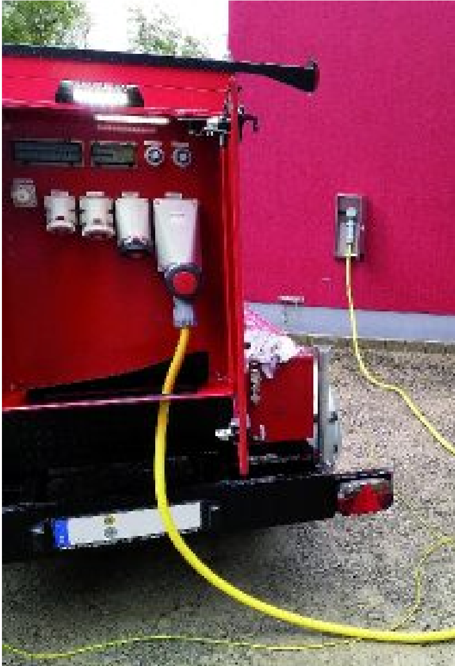
Multifunktionales Konzept von Polyma: AB-Strom/Licht 125 kVA mit Notstromautomatik und einem 8 m 3 großen Geräteraum.
