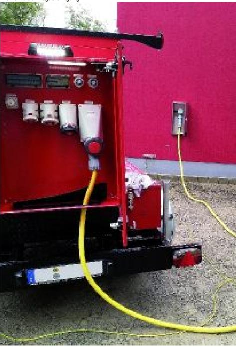
Multifunktionales Konzept von Polyma: AB-Strom/Licht 125 kVA mit Notstromautomatik und einem 8 m³ großen Geräteraum.
