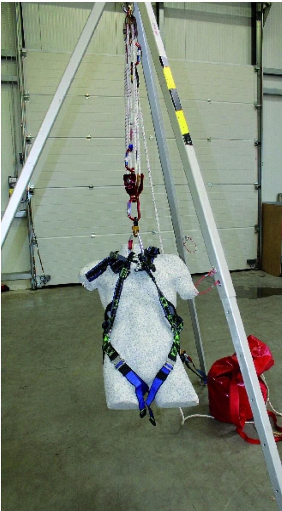
Das ProResc-MK-I-Gerät wird für das Auf- und Abseilen sowie Bergungseinsätze
