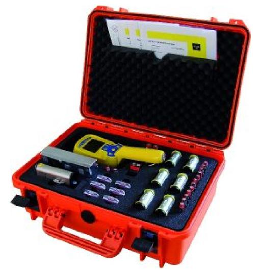
Graetz Messtruppkoffer GW-G/GPD für den A-Einsatz. Bestückung für Gerätewagen Gefahrgut entsprechend DIN 1455-12.
