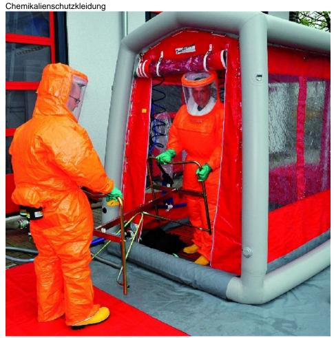
Der Schutzanzug ProChem-III der GM GmbH mit Haube und integriertem Gebläseatemschutz kann ohne Pressluftatmer getragen werden. Er ist in verschiedenen Ausführungen lieferbar.
