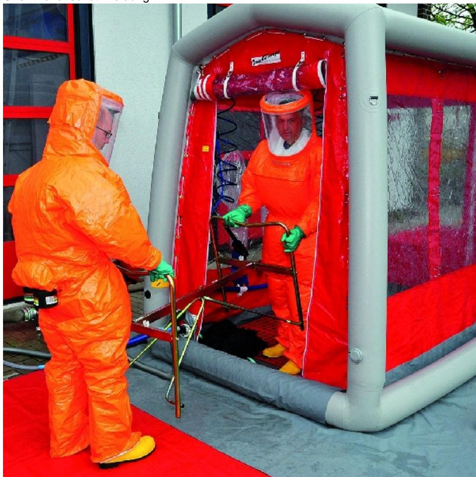
Der Schutanzug ProChem-III der GM GmbH mit Haube und integriertem Gebläseatemschutz kann ohne Pressluftatmer getragen werden. Er ist in verschiedenen Ausführungen lieferbar.
