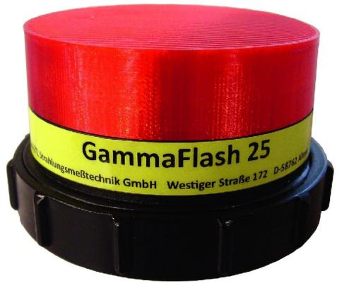
Graetz GammaFlash 25 zur einfachen Bestimmung der Absperrgrenze bei 25 µSv/h.
