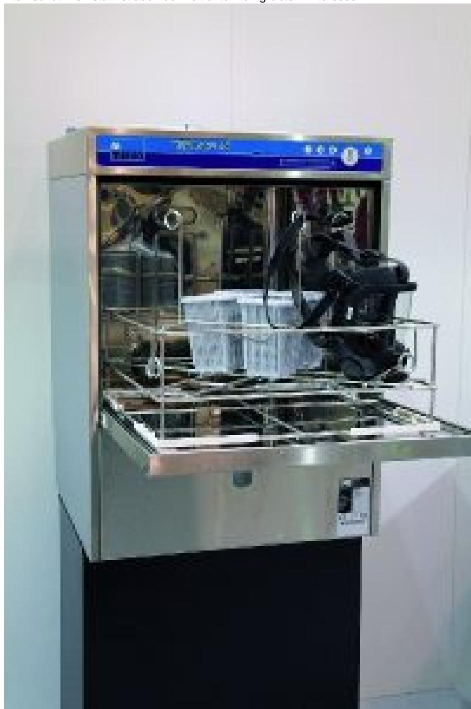
Mit dem Reinigungs- und Desinfektionsautomaten Meiko TopClean werden Masken und Lungenautomaten vollautomatisch gereinigt und desinfiziert.
