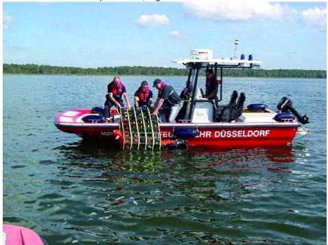
Das Personenrettungsgerät Typ 2 von Lehmar besteht aus einer Matte aus Kunststoffsegmenten, mit der die zu rettende Person schonend an der Bordwand »hochgerollt« und geborgen wird.
