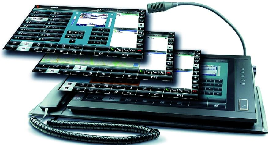
Eine passgenau konfigurierbare, modulare Kommunikationsplattform für Leitstellen – die neue Version Idecs 2.0 von Selectric Nachrichten-Systeme.
