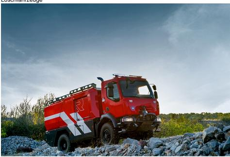
Kompaktes und geländegängiges Tanklöschfahrzeug mit modularem Leichtaufbau (Bild: Rosenbauer).
