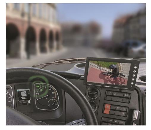
Die Kabinensicht unterstützt den Fahrer und hilft, Abbiegeunfälle durch den toten Winkel zu vermeiden (Bild: Axion AG).
