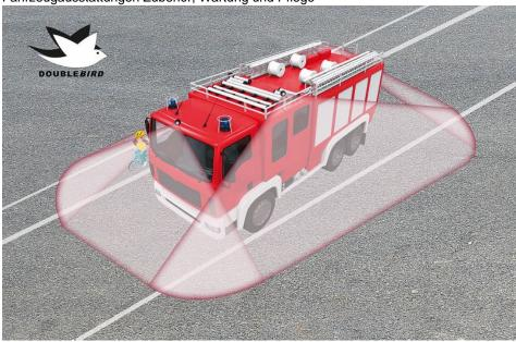
Das 360°-HD-Birdview-System bietet eine optimale Rundumsicht (Bild: Axion AG).
