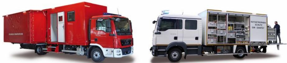
Der ELW2 mit ausklappbarem Besprechungsraum (links) ist eine Neuentwicklung von Ewers. Drei neue GW-San (rechts) hat das Land Sachsen-Anhalt für den Katastrophenschutz bestellt (Bilder: Ewers Karosserie- und Fahrzeugbau).
