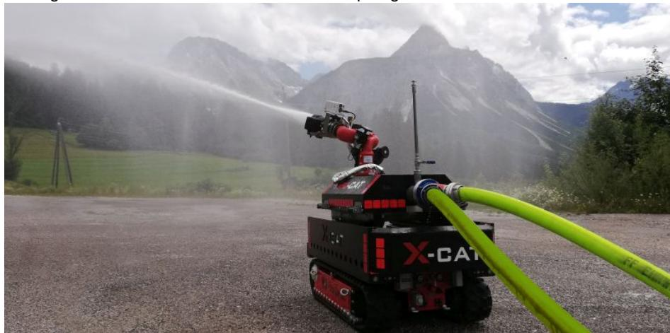
Das universelle Raupenfahrzeug »X-Cat« lässt sich auch zum voll ferngesteuerter Werfer mit Kameralösung konfigurieren (Bild: Jerg).
