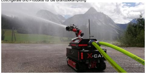
Das universelle Raupenfahrzeug »X-Cat« lässt sich auch zum voll ferngesteuerter Werfer mit Kameralösung konfigurieren (Bild: Jerg).
