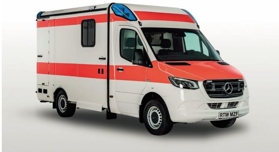
RTW-Kofferaufbau von System Strobel auf Basis des neuen MB Sprinters mit einer luftgefederten Patientenlagerung (Bild: System Strobel).
