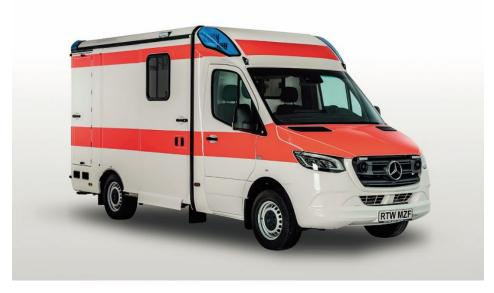
RTW-Kofferaufbau von System Strobel auf Basis des neuen MB Sprinters mit einer luftgefederten Patientenlagerung (Bild: System Strobel).
