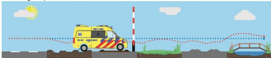
Die einstellbare Vollluftfederung gleicht verschiedene Fahrbahnoberflächen wirkungsvoll aus (Bild: VB-Airsuspension).
