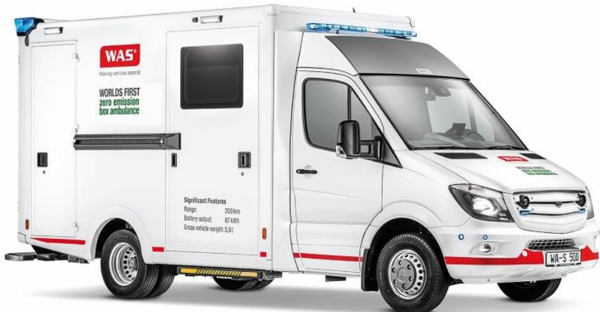
E-Mobilität im Rettungswesen – lohnt sich der Umstieg? Die E-Ambulanz mit Kofferaufbau ermöglicht mit seinem leistungsstarken Antrieb (Drehmoment von 1150 Nm) eine Höchstgeschwindigkeit von 120 km/h und überzeugt mit hohen Beschleunigungswerten (Bild: WAS).
