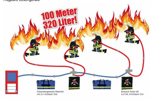
Mit der Waldbrandausrüstung lässt sich eine theoretische Einsatzfront von ca. 100 m entlang des Feuersaumes, bei einem Wasserverbrauch von lediglich 320 l/min, einfach und schnell aufbauen (Bild: rescue-tec).
