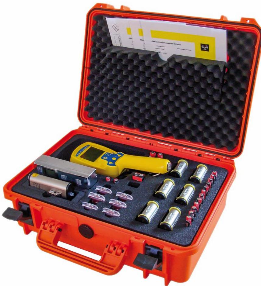
Messtruppkoffer »GW-G/GPD« für den A-Einsatz, Bestückung für Gerätewagen
