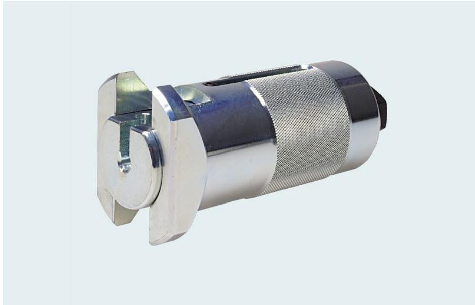
Die patentierte »ZIEH-FIX«-Glocke von Wendt ist zum Herausziehen des Schließzylinders aus dem Schlosskasten (Bild: A. Wendt).
