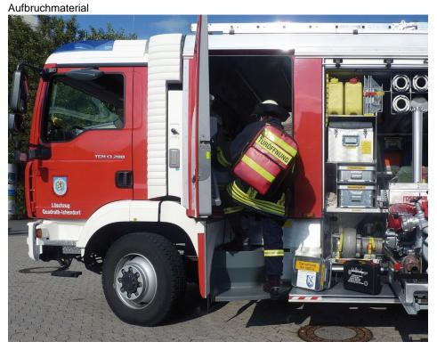
Bei in- und ausländischen Feuerwehren ist der bewährte Notöffnungsrucksack für Aufsperrtechnik von Wendt weit verbreitet (Bild: A. Wend).
