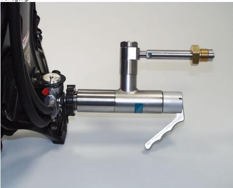
»TW156« zum Prüfen von Feuerwehr-Pressluftatmern (Bild: Weh).
