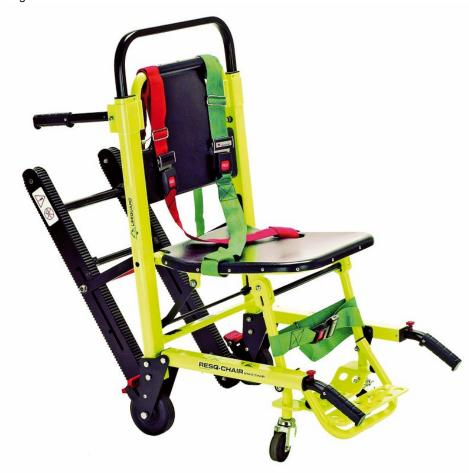
Der »Resq-Chair«, ein Transportstuhl, ist bis zu 227 kg belastbar und ermöglicht durch sein Raupen-System einen kraft- und rückenschonenden Treppenabstieg (Bild: Diaprax).
